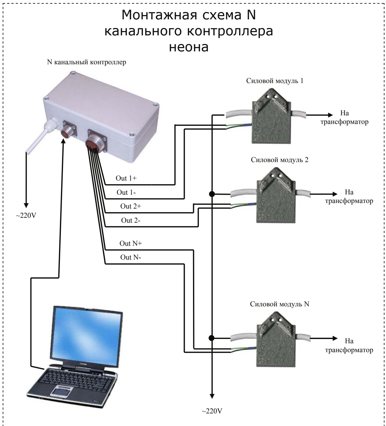
Рис. 1. Схема подключения нагрузки к контроллеру.
